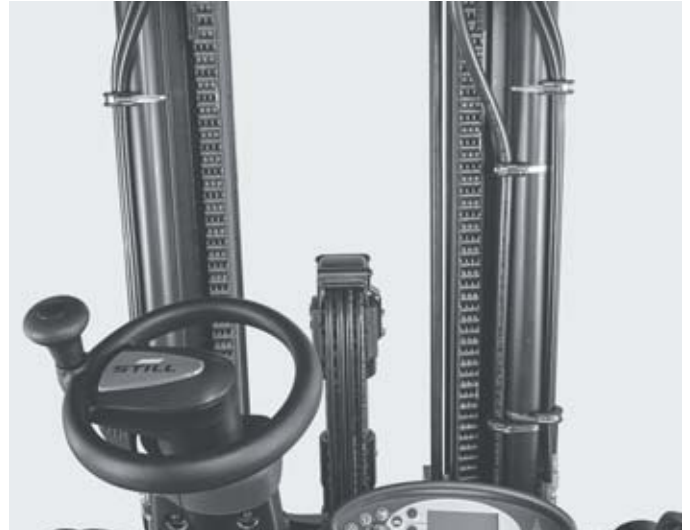
Freie Durchsicht beim Dreifach-Hubgerüst
